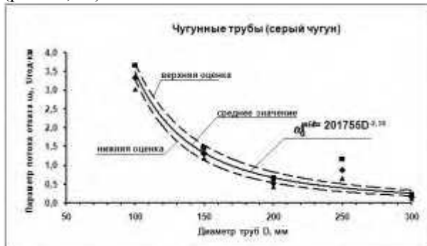
Рис. 13. Аналитическая зависимость \omega_0 = f(D) для чугунных труб г. Луцк Fig. 13. Analytical dependence \omega_0 = f(D) for iron pipes of Lutsk city
