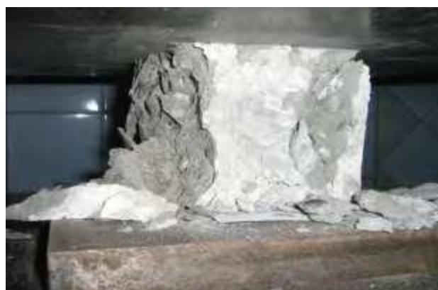
а) бетонный образец, который не вакуумировался
