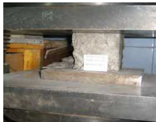
б) бетонный образец, который вакуумировался,
