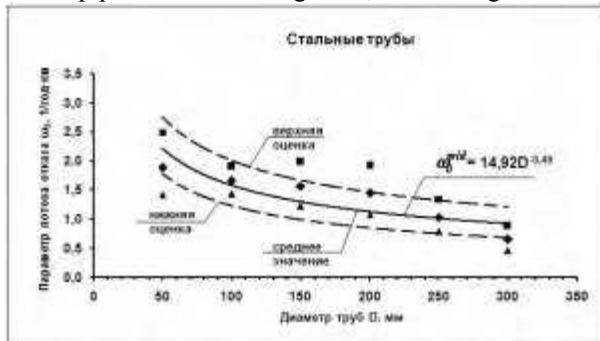
Рис. 12. Аналитическая зависимость \omega_0 = f(D) для стальных труб г. Кременчуг Полтавской области Fig. 12. Analytical dependence \omega_0 = f(D) for steel pipes of Kremenchug town, Poltava region
