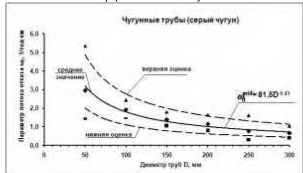
Рис. 15. Аналитическая зависимость \omega_0 = f(D) для чугунных труб г. Карловка Полтавской области Fig. 15. Analytical dependence \omega_0 = f(D) for iron pipes of Karlivka town, Poltava region
