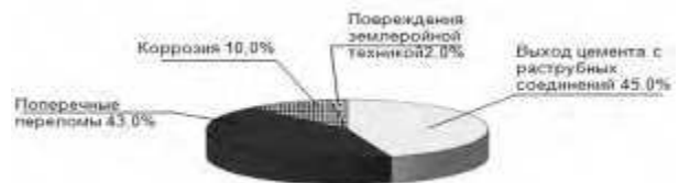
Рис. 1. Виды повреждений чугунных водопроводных труб г. Полтава
