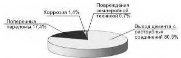
Рис. 5. Виды повреждений чугунных водопроводных труб г. Луцк Fig. 5. Types of defects of iron water pipes of Lutsk city
