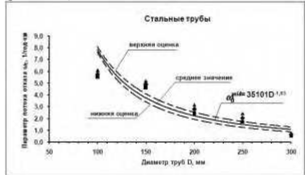
Рис. 14. Аналитическая зависимость \omega_0 = f(D) для стальных труб г. Луцк Fig. 14. Analytical dependence \omega_0 = f(D) for steel pipes of Lutsk city
