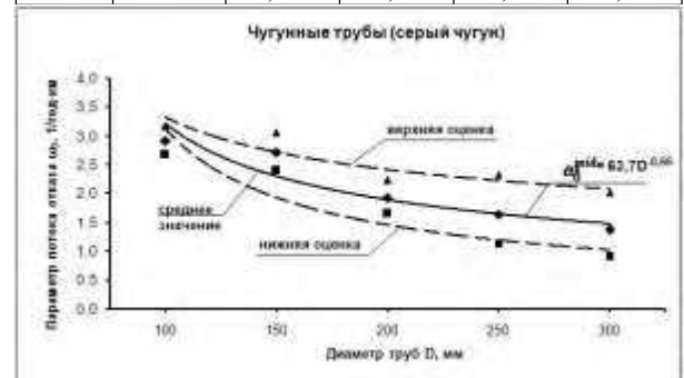
Рис. 9. Аналитическая зависимость \omega_0 = f(D) для чугунных труб г. Полтава
