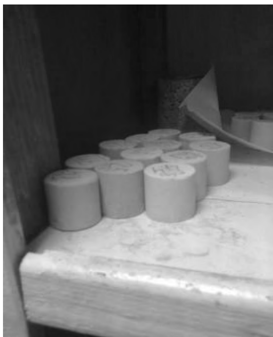
Рис.4. Образцы цилиндры из шлакощелочного бетона после ТВО при твердении 28 суток.
