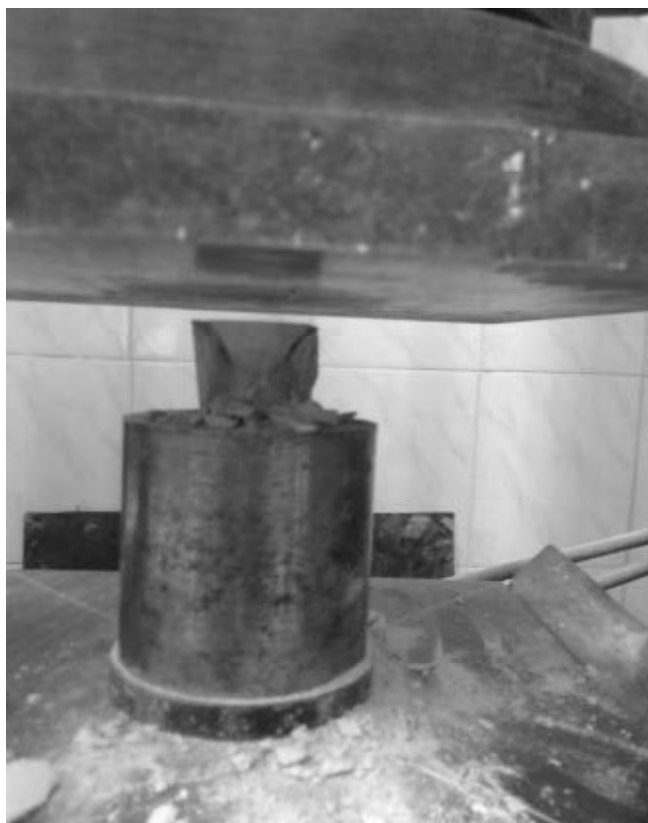
Рис. 1. Структура разрушения образца цилиндра диаметром 3 см после испытания на сжатие Fig. 1. Structure of breakup of the cylinder analyses diameter 3 cm after the test on compressing
