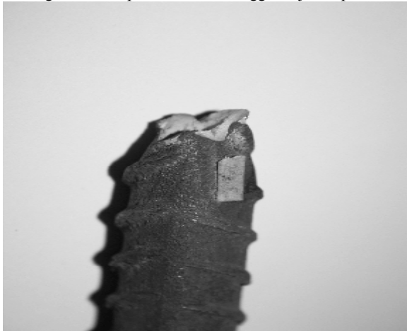
Рис. 12.. Короновидный долом стыков без смещенных накладок
