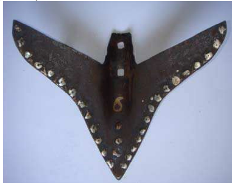
Рис.1. Экспериментальная стрелчатая лапа с криволинейной формой лезвия с нижним локальным упрочнением (вид снизу) Fig. 1. Experimental pointed paw with curved blades with lower local strengthening (bottom view)
