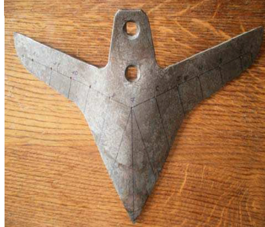
Рис. 3. Схема расположения точек на исследуемой монометаллической лапе Fig. 3. Location of control points in the investigated monometallic paw
