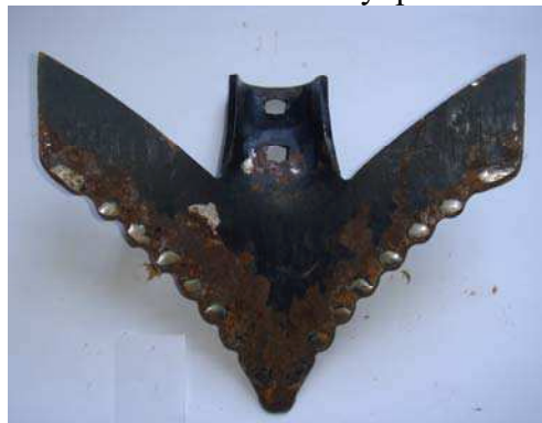
Рис.2. Культиваторная лапа фирмы «Case» с криволинейным зубчатым лезвием с нижним локальным упрочнением (вид снизу) Fig.2. Cultivator paw firm «Case» a curved serrated blade with lower local strengthening (bottom view)
