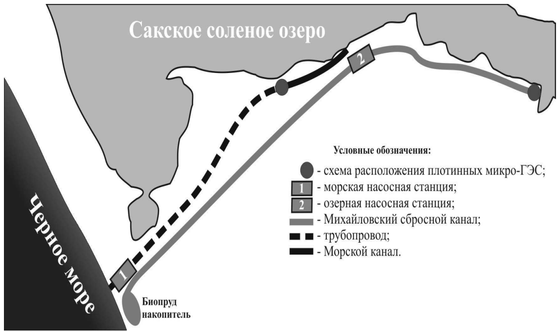
Рис. 1. Схема расположения плотинных мини-ГЭС Fig. 1. Arrangement of mini-HES dam
