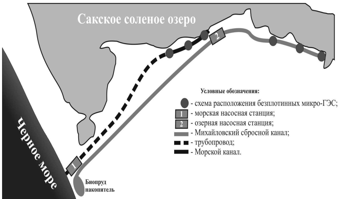
Рис. 2. Схема расположения безплотинных мини-ГЭС Fig. 1. Arrangement of mini-HES no dam
