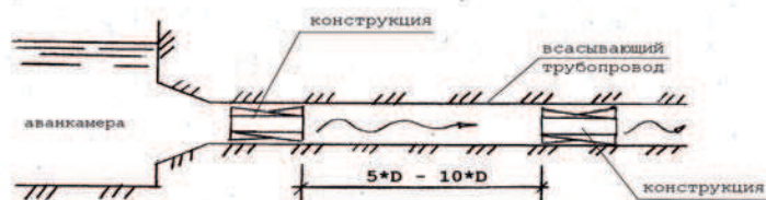
Рис.10 Схема установки устройства во всасывающий трубопровод Fig. 10 the Circuit of installation of the device in soaking up pipeline
