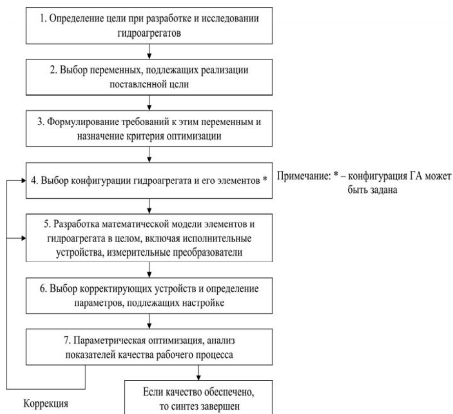
Рис. 1. Схема этапов синтеза Fig. 1. Scheme of synthesis stages
