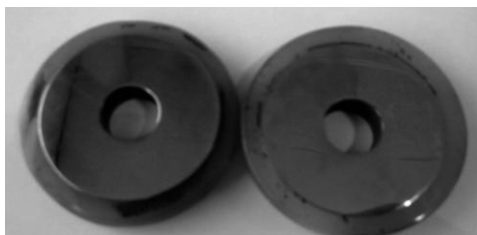
Рис. 5. Образцы подготовленные для исследования микротвердости Fig. 5. Obratzsi prepared for research of mikrotverdsti
