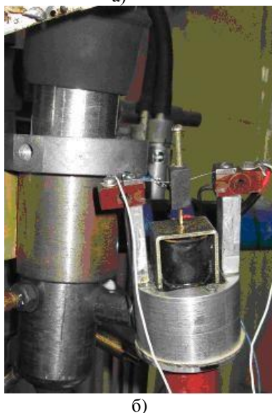
Рис. 1. Система "доильный стакан-пульсатор": а) схема системы; б) общий вид;
