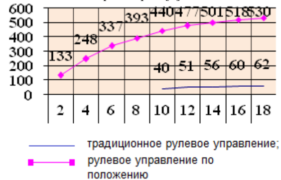
Рис. 1. Зависимость добротности рулевого управления от передаточного отношения
